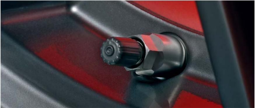
Les capteurs TPMS PLATIN Sens sont ce que l'on appelle des capteurs hybrides sur lesquels plusieurs protocoles d'équipement d'origine sont déjà installés. Les capteurs hybrides PLATIN Sens couvrent environ 90 % des besoins du marché.
